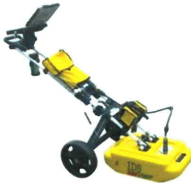
Figura 1. Equipo de georadar DUO, vista del levantamiento y marca provisional in situ.
