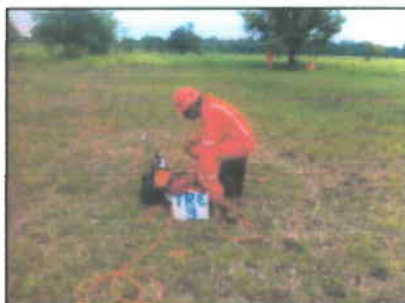
Figura 5. Adquisición de Tomografía Eléctrica ARES G4 (GF Instruments).
